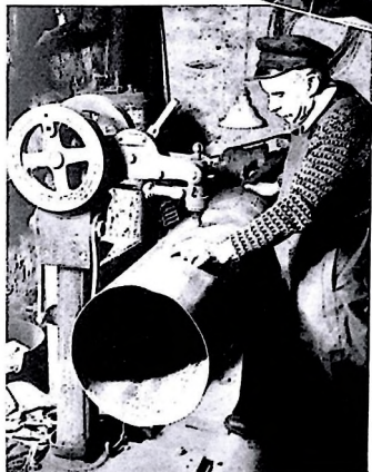
Kopparslagaremästare M. P. Bändelin kände sitt yrkes alla detaljer från grunden. Här granskar han en blivande varmvattenberedare.
